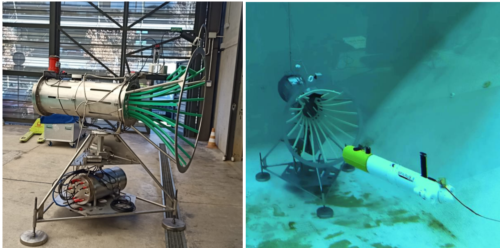
Figure 3: Docking Station photographs in the surface and into the CIRS (Centre d'Investigació en Robòtica Submarina) water tank with the Sparus II.
