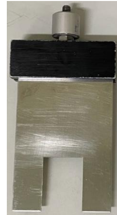
Figura 4.5. Fulla de ganivet emprada per executar Shear Test
