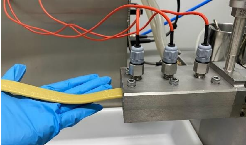
Figura 2.6. Producte sortint de la matriu de refredament ( cooling die ) després de l'extrusió humida.
