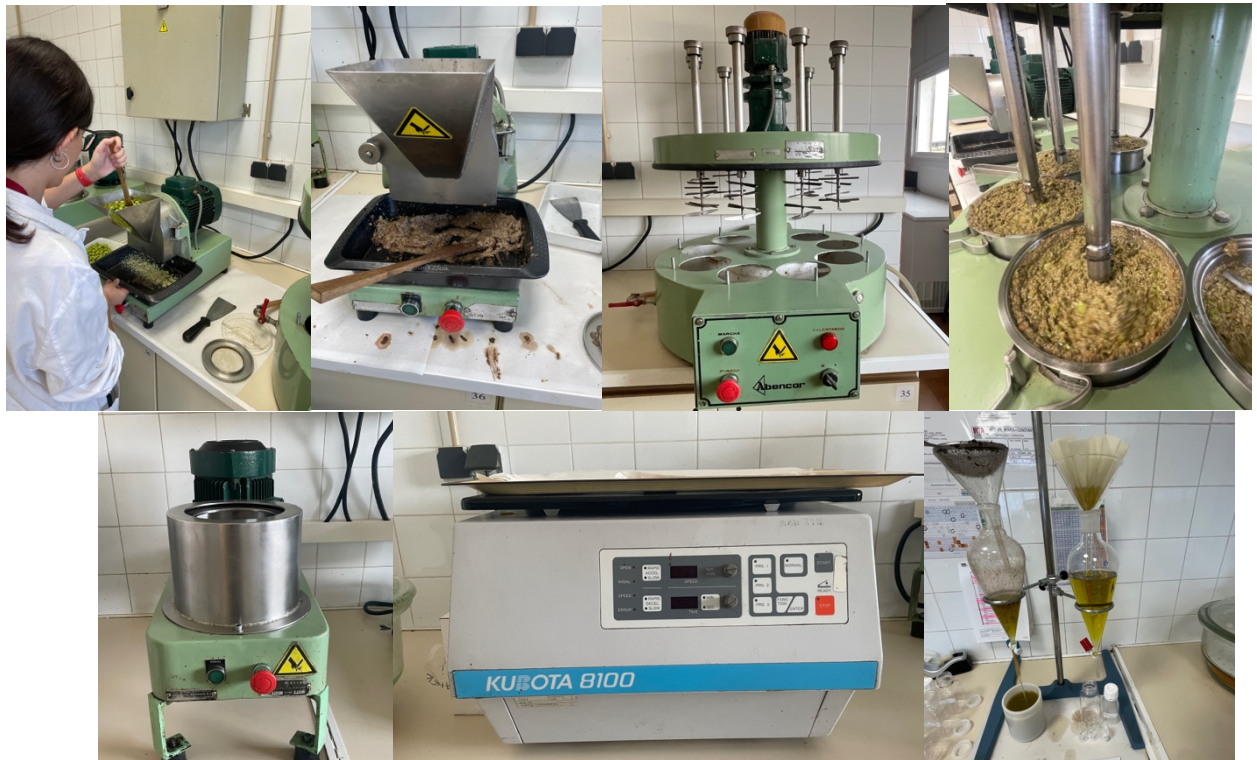
Figura 11: Procés gràfic d'extracció de l'oli: a) trituració, b) pasta obtinguda, c) Batedora Abencor, d) Cassons amb pasta d'oliva a la batedora, e) Centrifuga Abenco, f) Centrifuga Kubota, g) Embut de decantació. Font: pròpia
