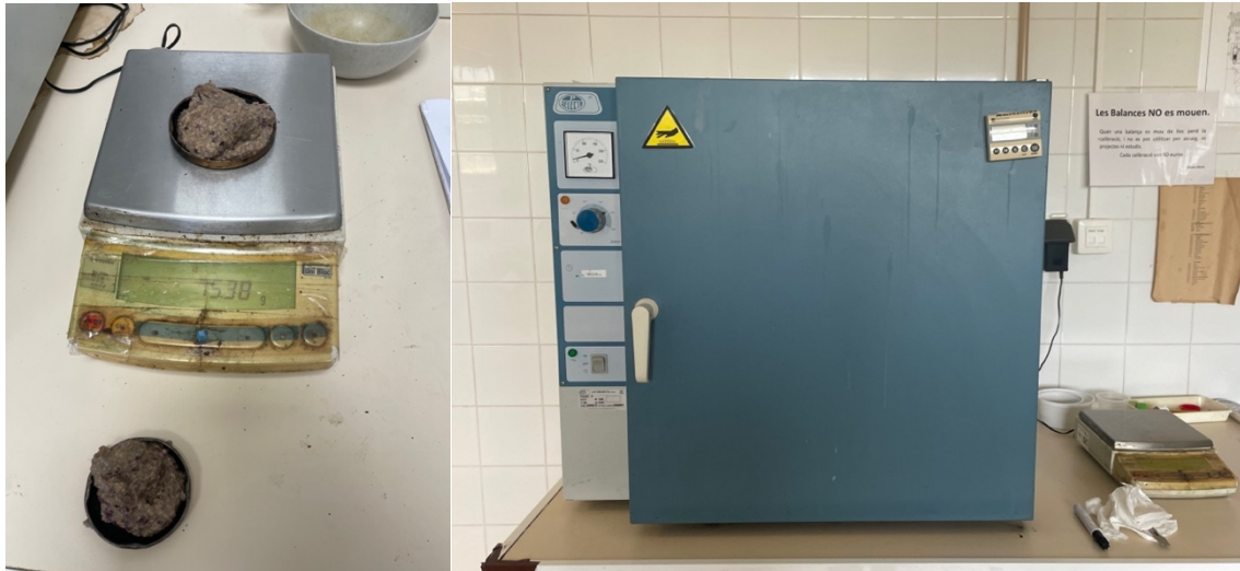
Figura 9: Exemple de presa de mostres de la pasta d'oliva i estufa utilitzada ens els procediments esmentats. Font: pròpia
