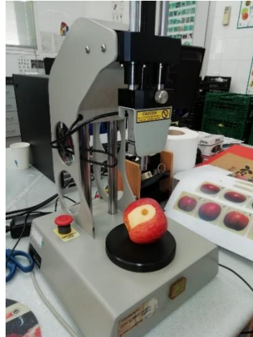
Figura 9. Fruit Texture Analyzer GS-14 (penetròmetre digital automàtic). Font: pròpia
