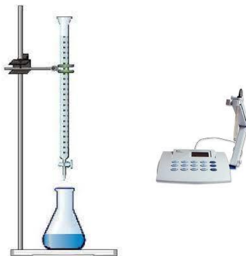
Figura 12. Valoració àcid base per l'obtenció del contingut en g/L d'àcid màlic (Pràctica, El bloc de QuercusLab (2022)).
