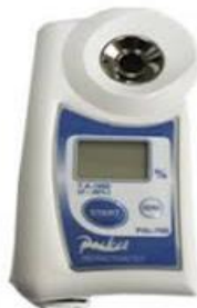
Figura 11. Refractòmetre digital per obtenir el contingut de sòlids solubles dels fruits (Invia1912, 2022).
