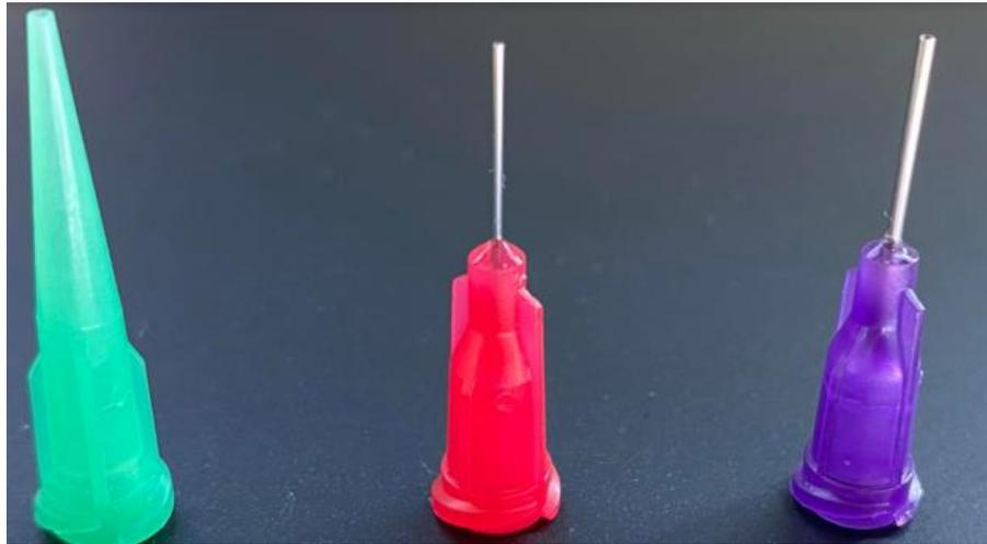
Figura 2 Evolución de las agujas utilizadas en la impresión
