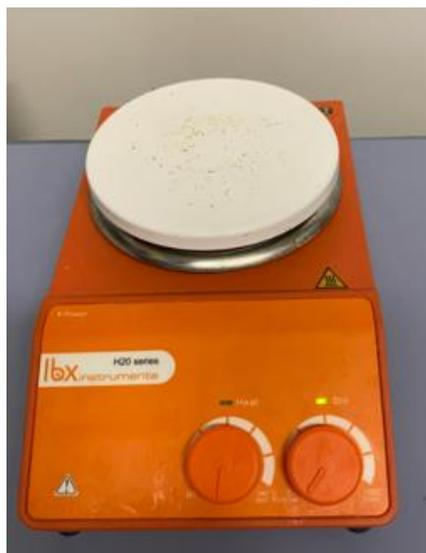
Figura 14 Agitador magnético
