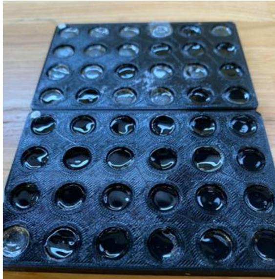
*Figura 23 Probetas PVA para ensayo degradación*
