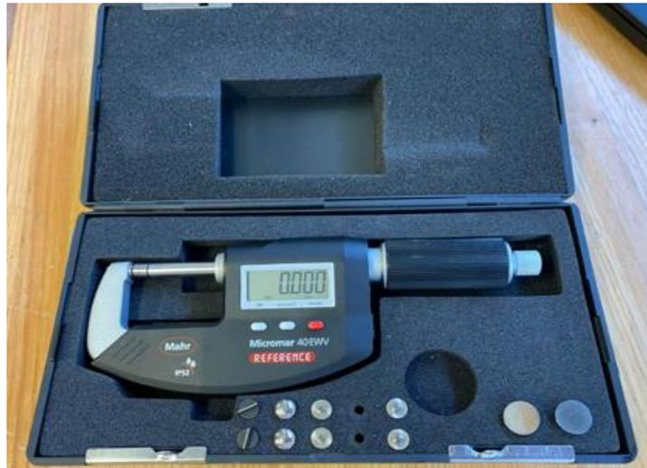
Figura 20 Micrómetro utilizado para medir la expansión
