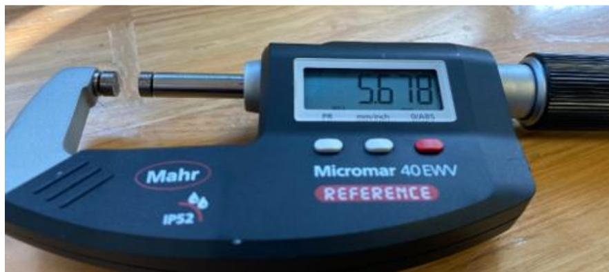
Figura 21 Medición de la expansión utilizando el micrómetro
