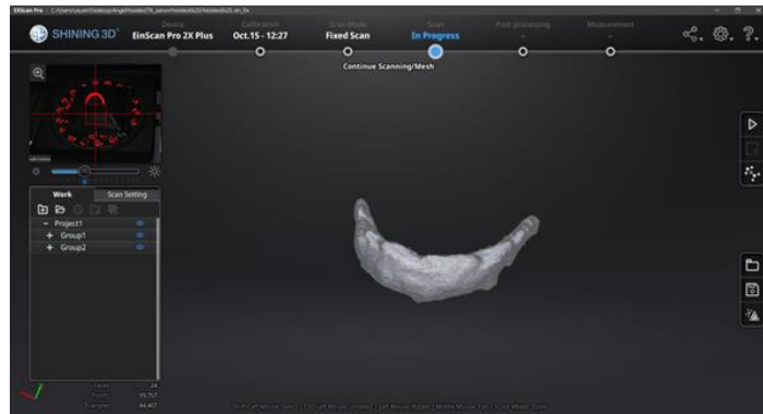
Figura 28. Captura de pantalla del modelo escaneado después de alinear ambas partes.
