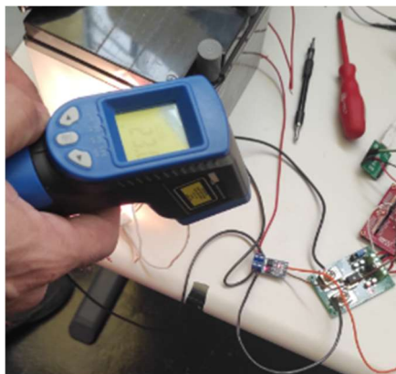
Figura 68. Mesura de temperatura del MOSFET.
