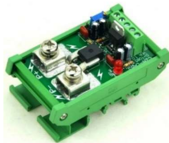
Figura 21. Sensor ACS758 en el carril DIN.
