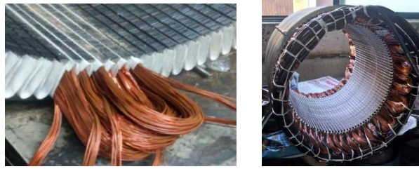
Figura 25. Devanado del estator
