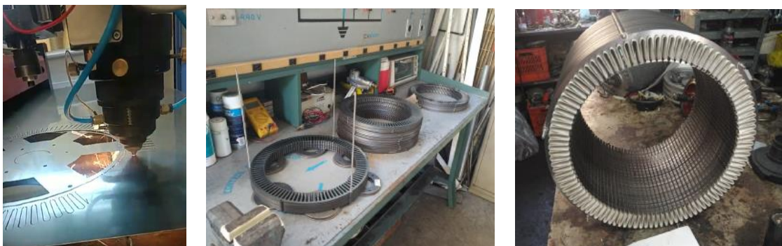
Figura 24. Construcción del núcleo del estator
