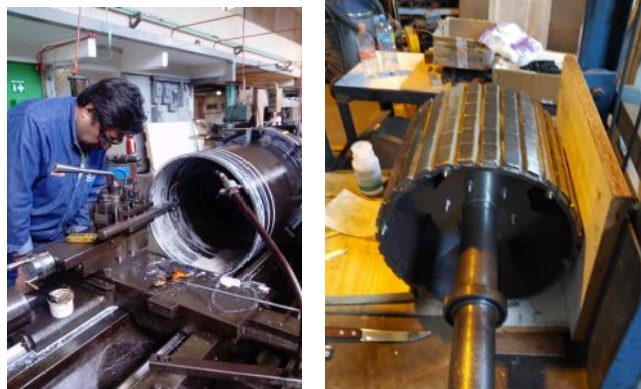
Figura 26. Construcción de la carcasa del estator (izquierda) y del rotor de imanes permanentes (derecha)
