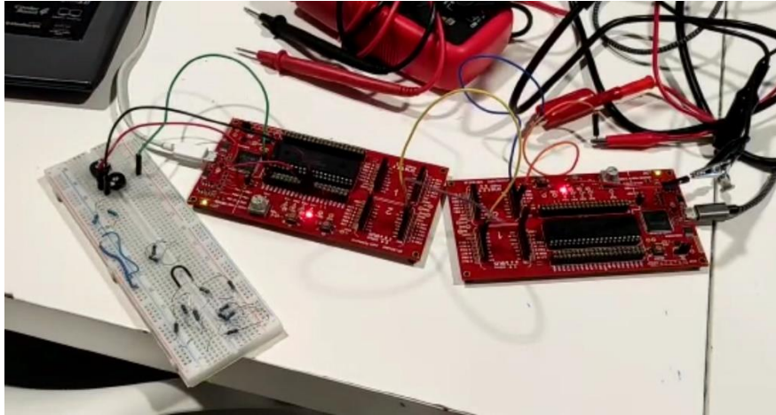
Figura 77: Connexió entre els microcontroladors - prova de comunicacions I2C
