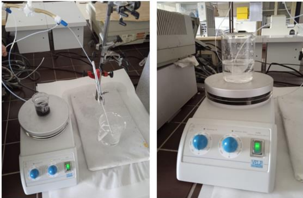
Figura 36: A la izquierda, las nanopartículas y el alginato se homogeneizan sobre el agitador magnético mientras se elimina el oxígeno de la solución de cloruro cálcico, a la derecha, la solución de cloruro cálcico lista sobre el agitador para que se inicie la esferificación.
