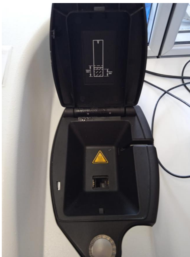
Figura 29: Ranura para incorporar las cubetas y proceder a realizar los análisis.
