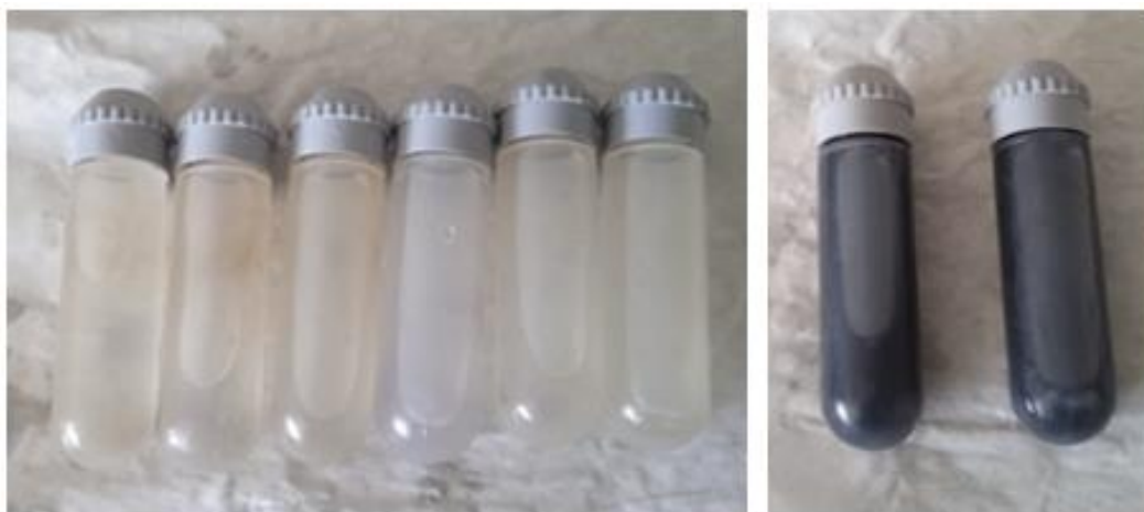
Figura 27: A la izquierda, los recipientes especiales para la centrifugadora repletos de agua para compensar los espacios vacíos, a la izquierda, los recipientes con las muestras
