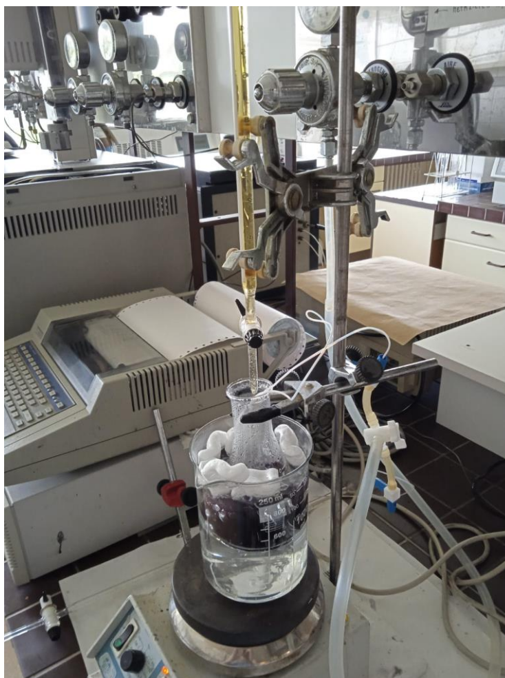
Figura 35: Montaje usando el erlenmeyer.
