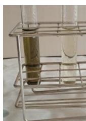
Figura 44: Solución de nanopartículas de hierro con un tono verdoso en una muestras diluida.
