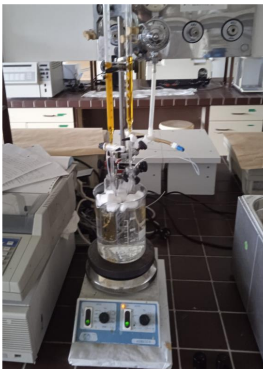
Figura 34: Montaje para la síntesis simultánea de dos muestras.
