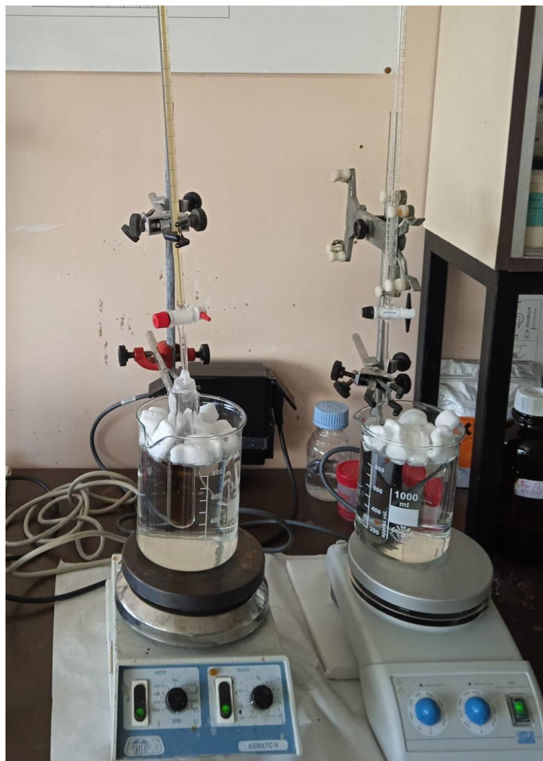
Figura 33: Montaje para la síntesis de nanopartículas de hierro cero usando agitadores magnéticos como sustitutos del baño termostático.
