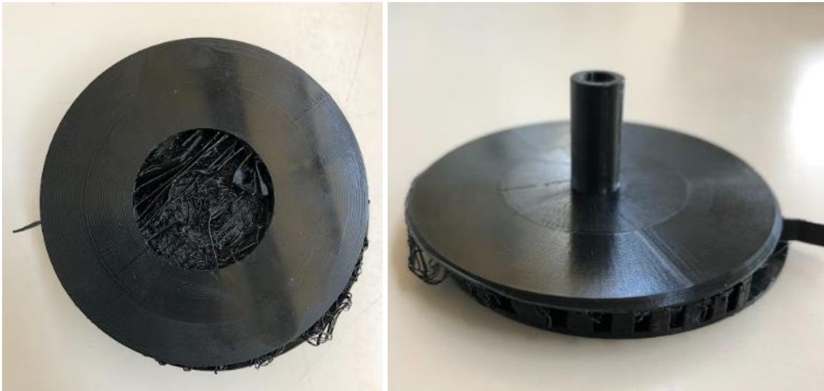
Figura 64. Desfasament en la impressió del primer disseny
