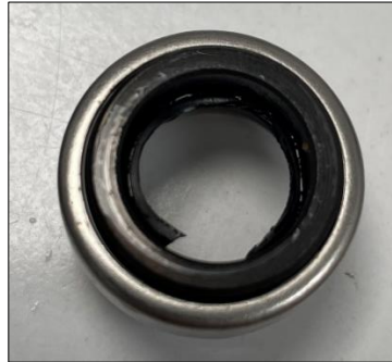
Figura 69. Trencament de la goma del premsaestopes
