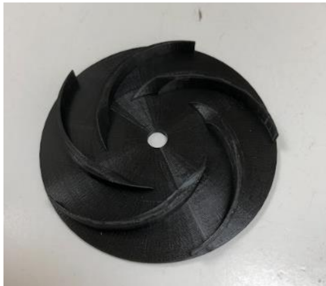
Figura 66. Impressió dels àleps i la base del rodet
