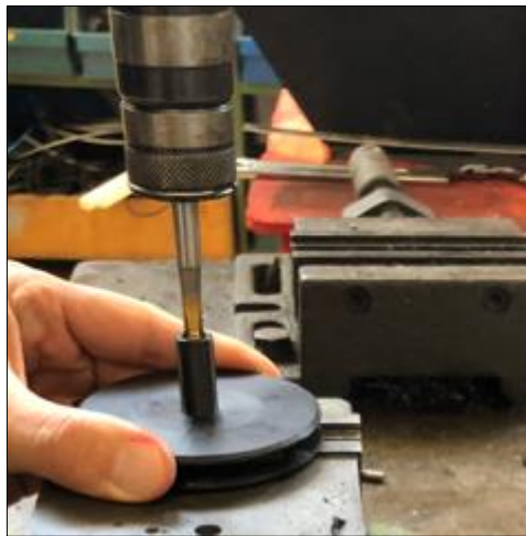
Figura 77. Roscatge de la part interna de l'eix del rodet
