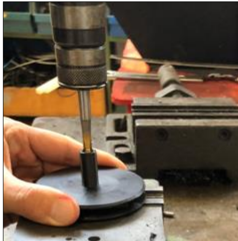
Figura 41. Roscatge de la part interna de l'eix del rodet
