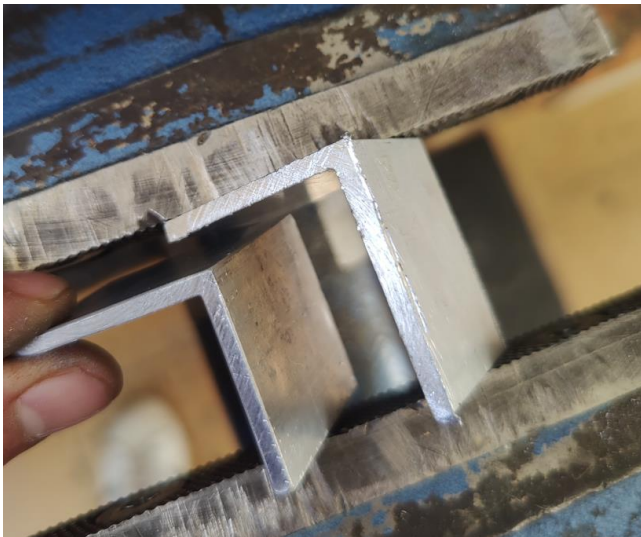
FIGURA 94: RESULTAT DE PASSAR LA TELA ESMERILADORA
