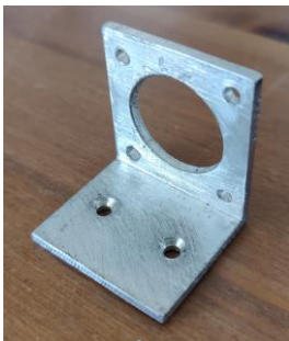
FIGURA 33:MECANITZADA AMB LA FRESADORA
