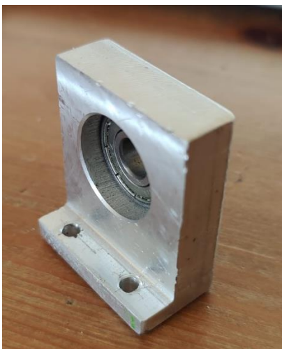
FIGURA 41:SUPOORT DEL RODAMENT BASE 2 MECANITZAT AMB LA FRESADORA
