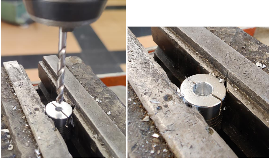
FIGURA 71: ACOBLAMENT COLLAT I MECANITZAT EN EL TREPANT
