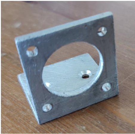
FIGURA 37: SUPORT DEL MOTOR BASE 2 MECANITZAT AMB FRESADORA
