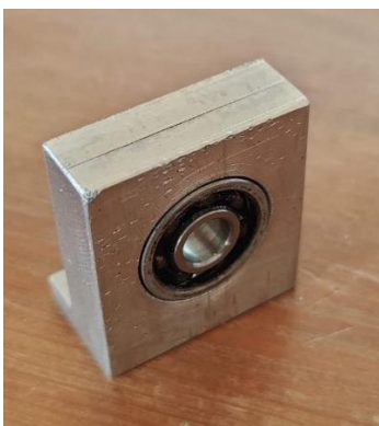
FIGURA 39: SUPORT DEL RODAMENT BASE 1 MECANITZAT AMB LA FRESADORA
