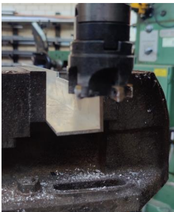
FIGURA 34:REBAIX SIMULTANI AMB LES PECES SENSE TALLAR
