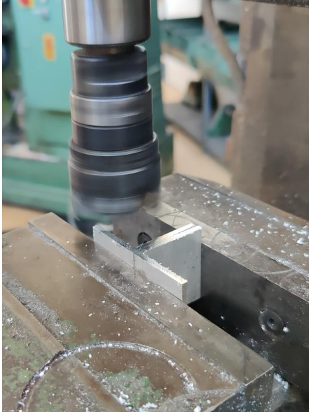
FIGURA 35:REBIX SIMULTANI AMB LES PECES TALLADES
