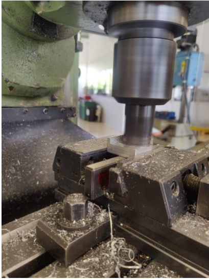
FIGURA 92:MECANITZACIÓ DEL SUPORT DEL RODAMENT
