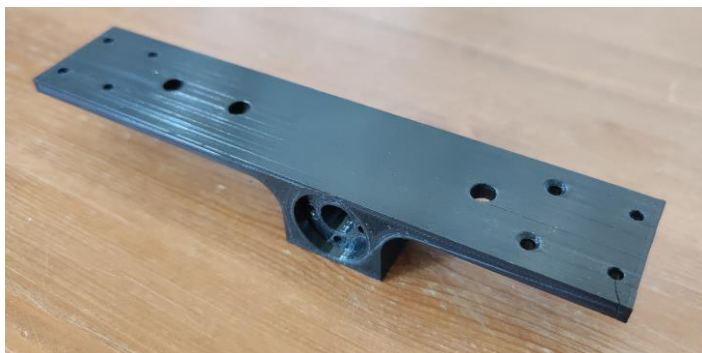
FIGURA 30:BASE 2 IMPRESA EN PLA
