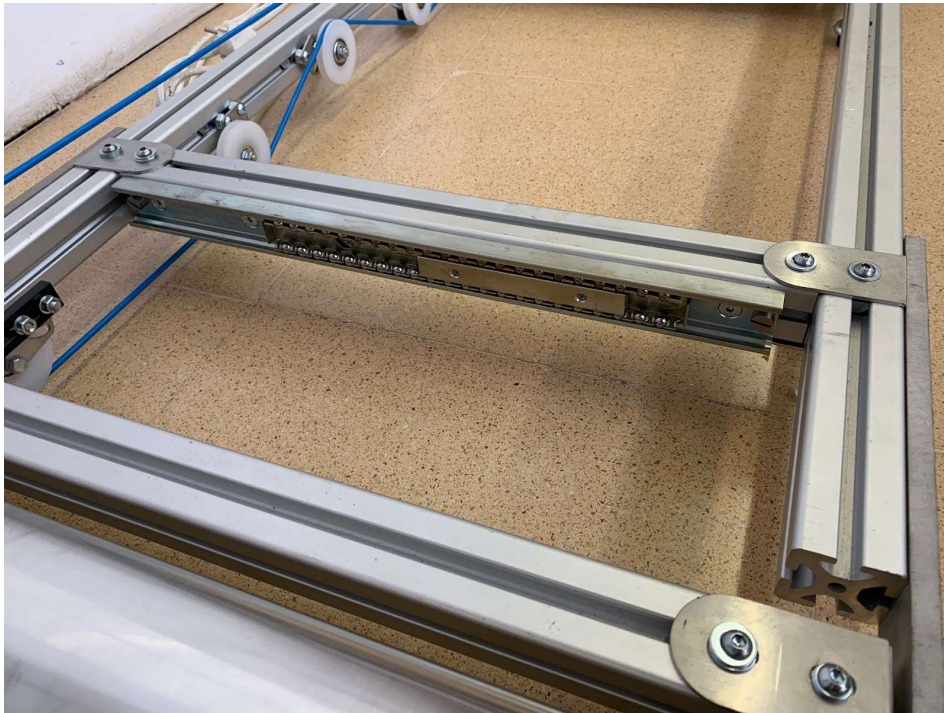
Figura 37. Conjunt guiatge linea i perfil fixats al banc
