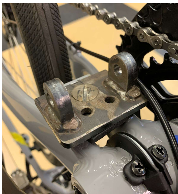
Figura 46. Col·locació del conjunt soldat al quadre de la bici
