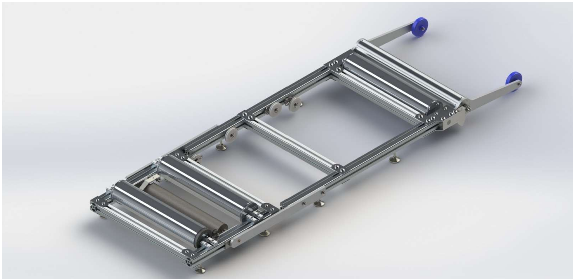
Figura 1. Banc de corrons de bicicleta lliure amb simulació de pujada
