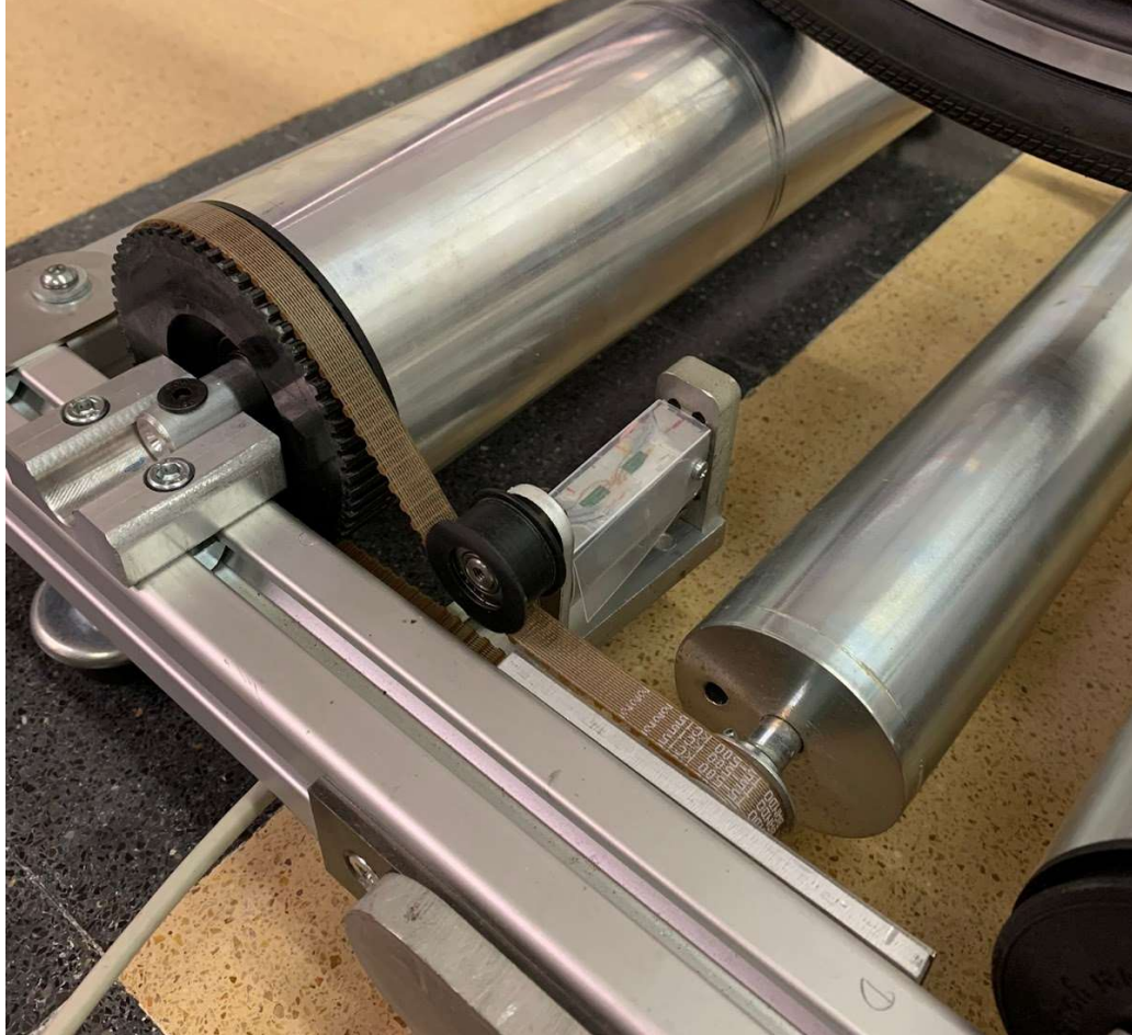
Figura 57: Sistema de monitoratge de l'exercici instal·lat al banc de corrns
