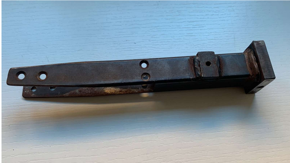
Figura 39. Tub basculant amb el reforç i la placa soldats
