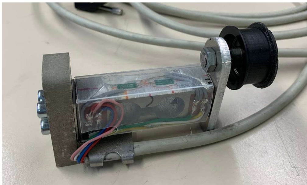
Figura 55. Instal·lació muntatge eix i protecció captador
