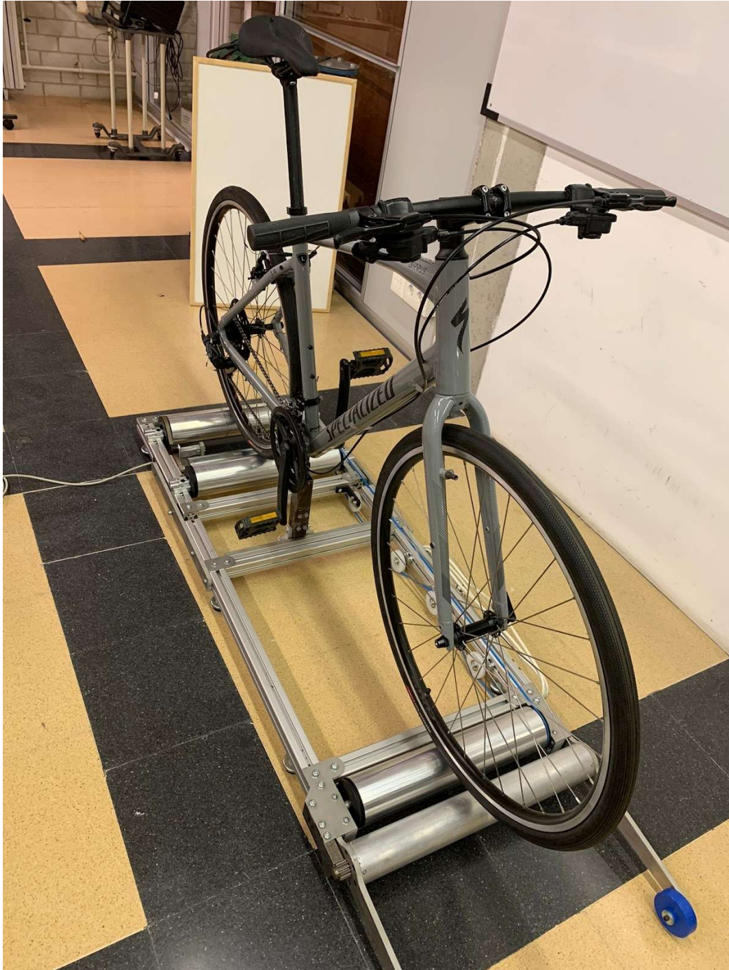
Figura 49. Vista general del peu d'equilibri al banc amb la bicicleta
