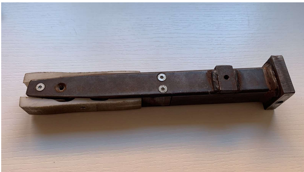
Figura 42. Muntatge tope falca superior, inferior i falca
