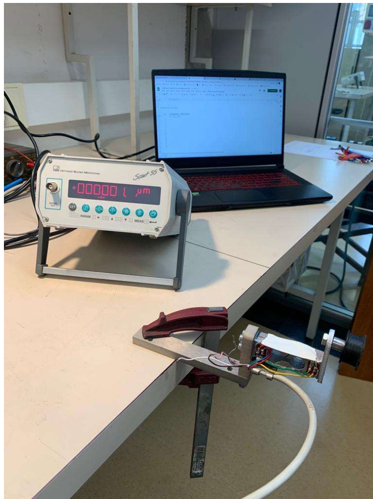
Figura 30. Comprovació de la sensibilitat del captador
