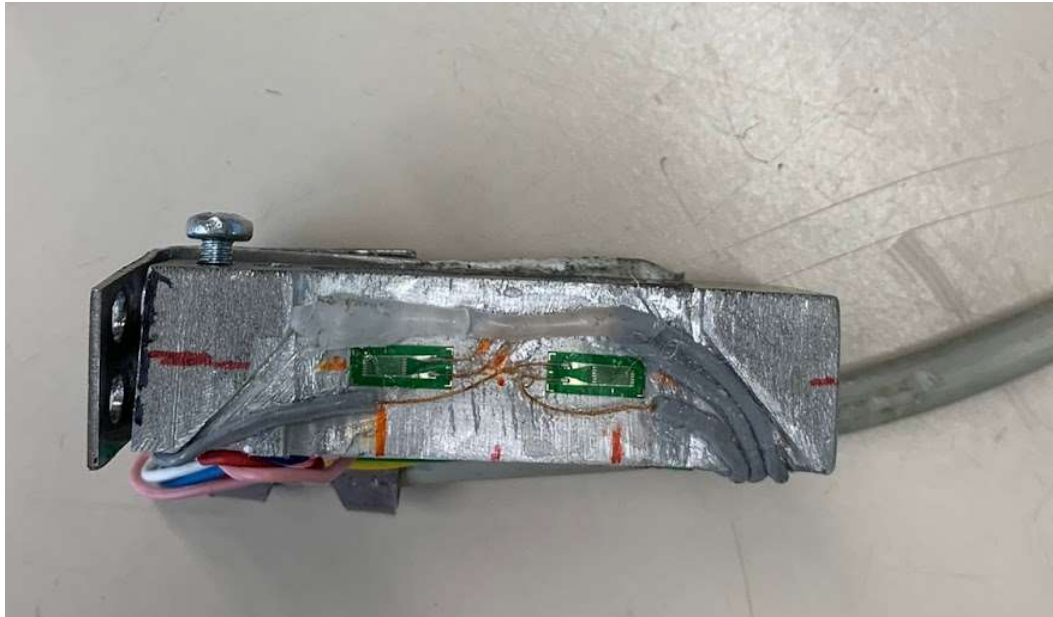
Figura 50. Vista superior del captador amb el sistema de galgues
