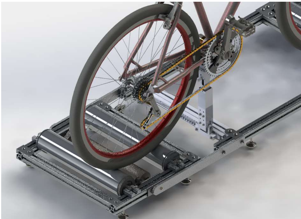
Figura 5. Posicionament del peu d'equilibri al banc de corrons
