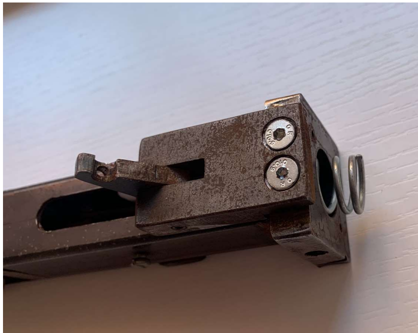
Figura 44. Fixació tapa mecanisme i ubicació molla
