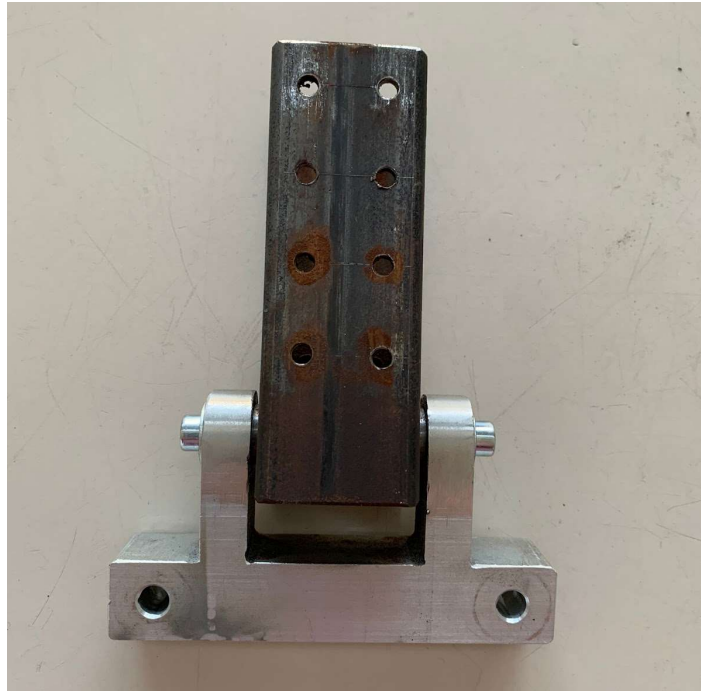
Figura 35. Base articulació i conjunt soldat muntat
