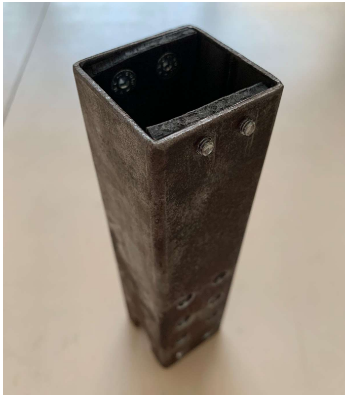
Figura 34. Fixació topes al tub inferior
