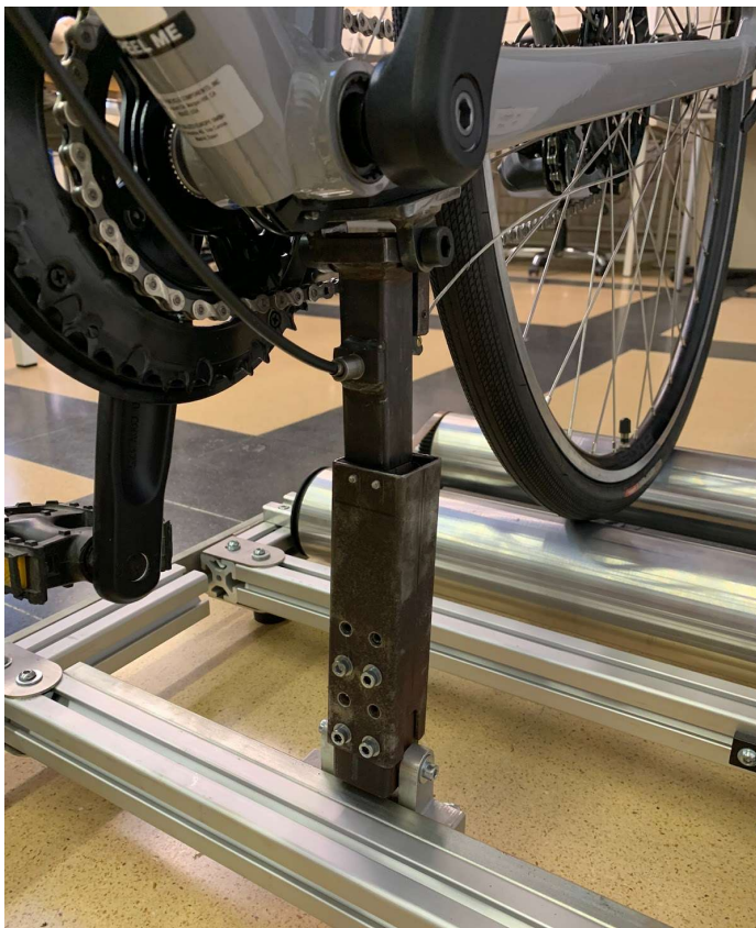
Figura 48. Peu d'equilibri instal·lat completament
