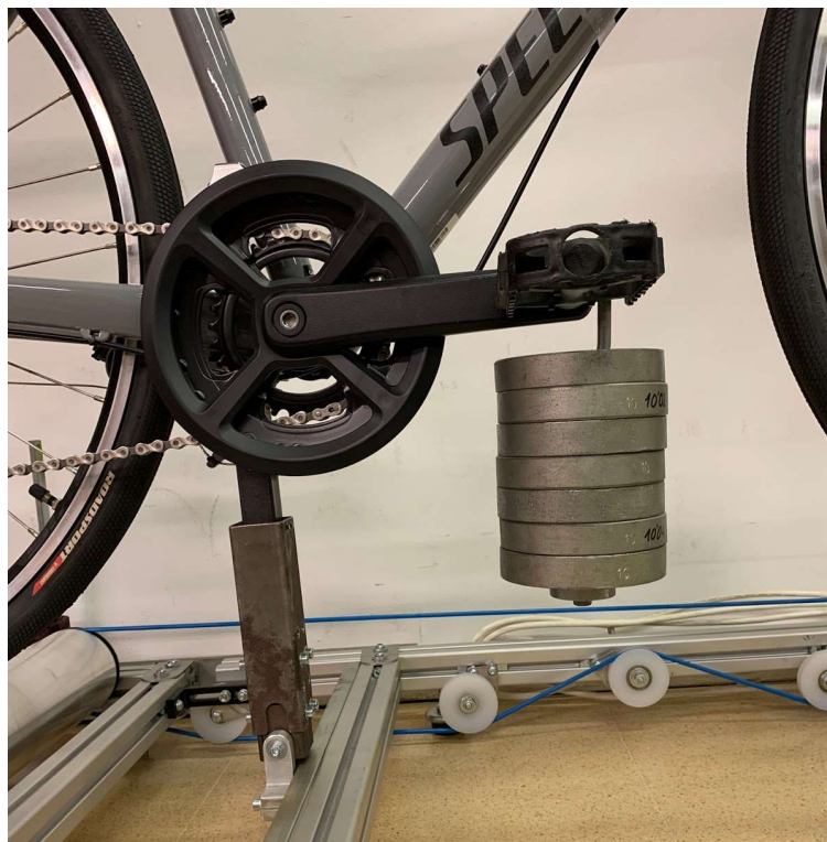
Figura 33. Lloc d'aplicació del pes per la última comprovació
