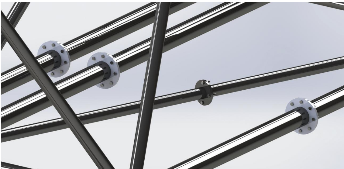
Figura 11: Unió dels perfils circulars.
