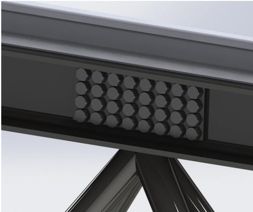
Figura 10: Unió dels perfils HEB 260.
