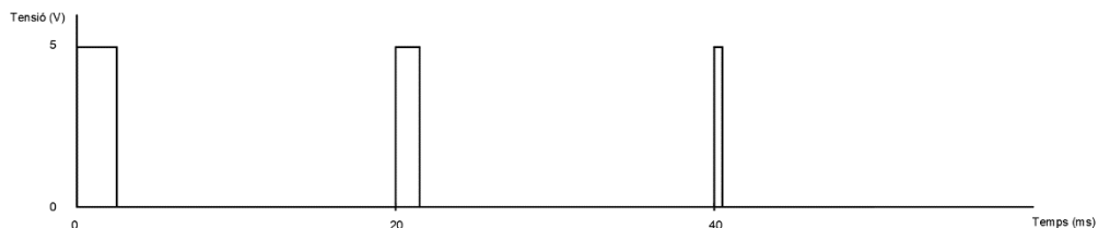
Figura 3. Senyal de control PWM d'un servomotor.
