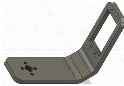
Figura 14. Braç dels servos del roll i pitch.
