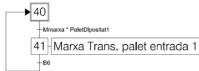
Figura 12. GRAFCET Transport corrone palet entrada 1
