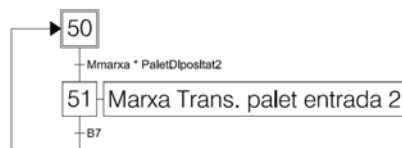
Figura 13. GRAFCET Transport corrone palet entrada 2
