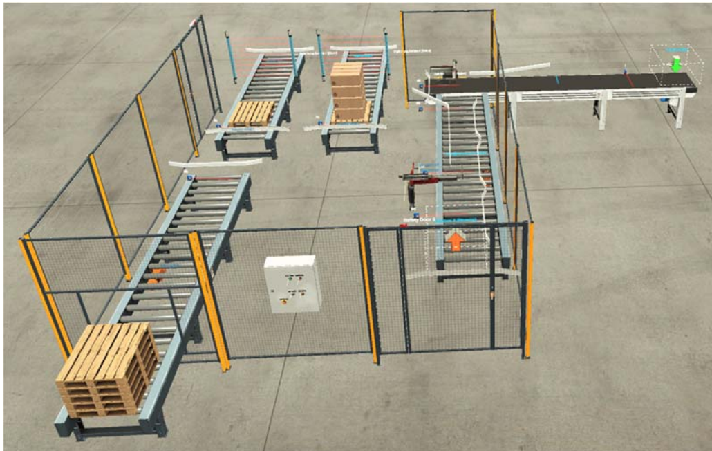
Figura 2. Situació nova instal·lació en 3D.
