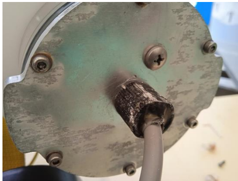
Figura 87. Tapa d'alumini oxidada.
