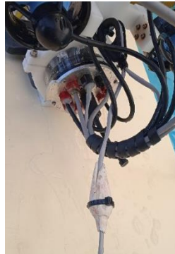
Figura 48. Utilització del "Tether cable thimble" i el mòdul de flotació en el cable CAT5E del ROV.
