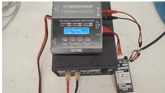
Figura 91. Carregador de bateries amb els connectors del subconn al corresponent lloc.
