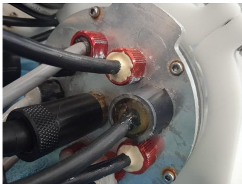
Figura 86. Driver cremat durant les proves amb el robot fora l'aigua.
