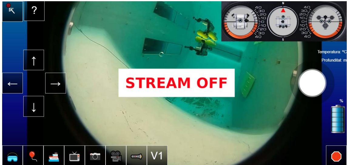
Figura 64. Pàgina de control de la interfície web del Girona 25 per telèfons mòbils.
