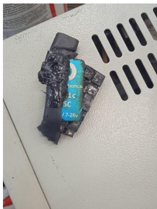
Figura 85. Driver cremat durant les proves amb el robot fora l'aigua.
