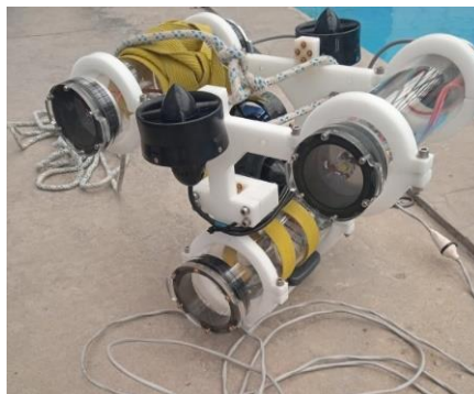
Figura 83. Muntatge de pesos per poder fer enfonsar el ROV.
