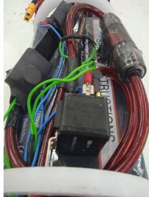
Figura 42. Relé instal·lat amb al resta de l'electrònica.
