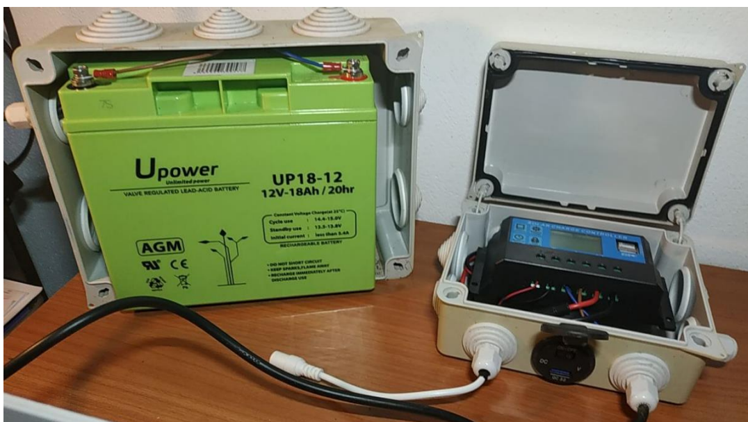
Figura 16. Interior del mòdul de la bateria (esquerra) i el mòdul de distribució de l'energia (dreta)
