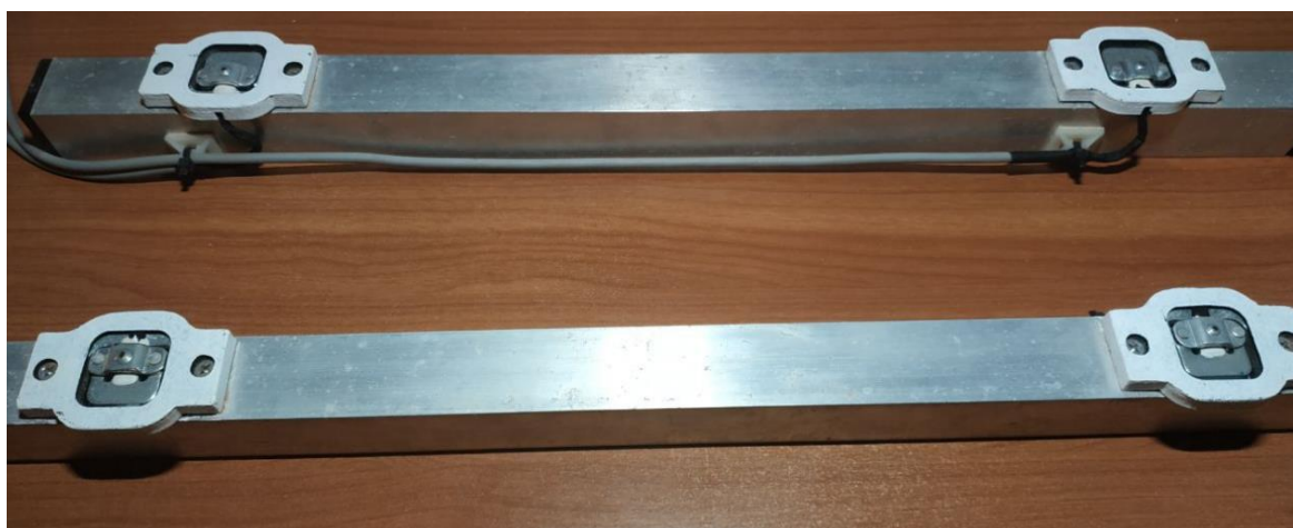
Figura 15. Barres d'alumini amb les cèl·lules de càrrega muntades
