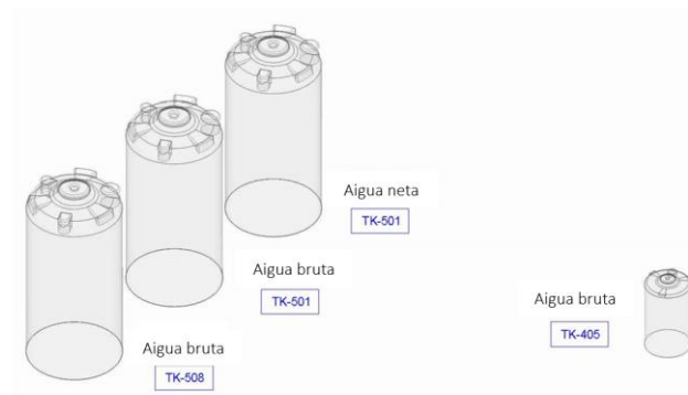
Figura 6.31. Disseny dels tancs pulmó d'aigua neta i aigües descartades. Imatge extreta de Talleres Azuara S.L. (2018).
