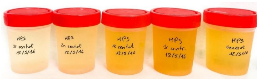
Figura 3.6. Fraccions de sobrenedant recollides en l'etapa d'eliminació d'aigües després del rentat del producte proteic procedent de sang porcina, obtingut a escala de laboratori mitjançant el mètode de Florido (2008). D'esquerre a dreta: tercer rentat, segon rentat, primer rentat, aigües mare (sobrenedant recuperat) i aigües generals mesclades.
