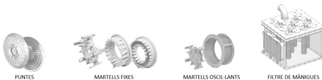
Figura 6.22. Discs micronitzadors del molí i filtre de mànigues. Figura modificada a partir d'Azuara (2018).
