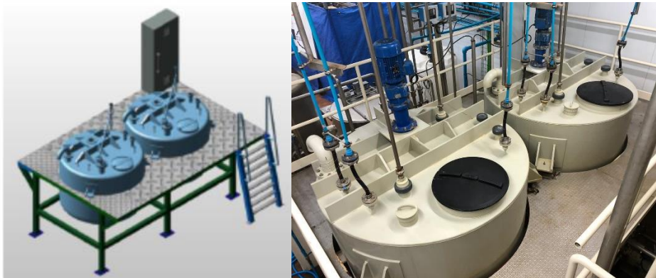
Figura 6.8. Disposició dels reactors tècnics sobre la plataforma (esquerra) i acabat final (dreta). Figura esquerra extreta d'Azuara S.L. (2019).
