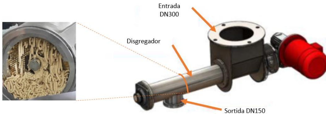
Figura 6.17. Representació del disgregador i detall de la sortida de producte. Figura modificada a partir d'Azuara (2018).
