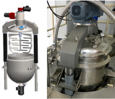
Figura 6.11. Disseny del triagi (esquerra) i equip instal·lat a la planta pilot (dreta). Figura esquerra extreta d'Azuara S.L. (2018).
