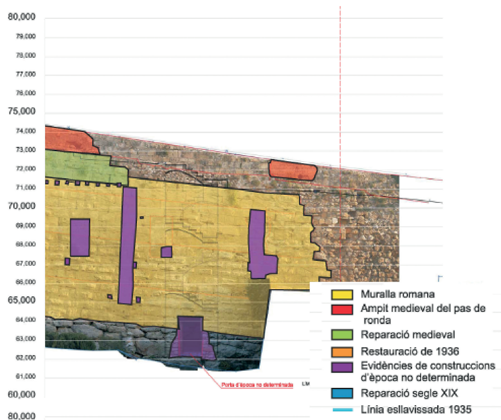
Fig. 25. Parament exterior del tram de muralla de la Baixada del Roser, corresponen a l'entrada del passeig Arqueològic. S'hi veuen les traces d'una torre adossada, i les obertures d'habitatges que aprofitaven l'interior de la defensa romana (base Figuerola et al. 2008).
