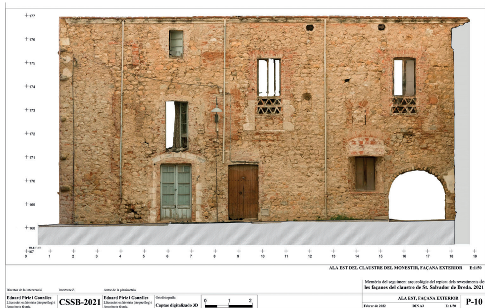
Figura 20. Aixecament fotogramètric un cop enretirats els revestiments actuals de a façana exterior de l'ala est del claustre del monestir. FEB/2022 (E. Píriz-Captae Digitalizado 3D).
