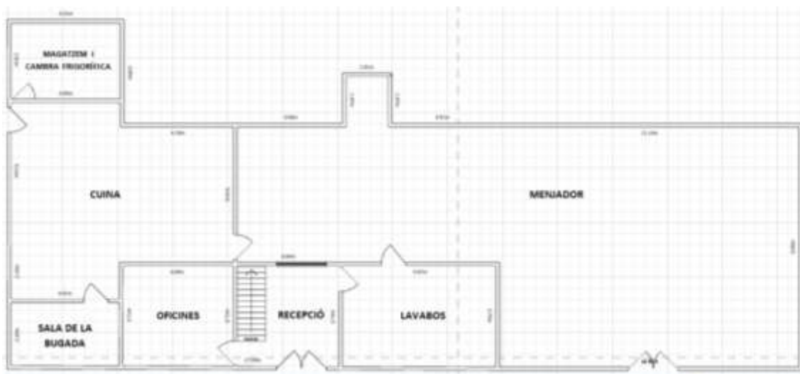
Figura 6. Plànols post-reforma de la primera planta del Mas Rimbau. Font: Elaboració pròpia.
