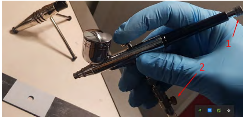
Figura 4.6. Fabricación de patrones de puntos con aerógrafo: : (1) entrada de caudal de aire (2) entrada de inyección de tinta.
