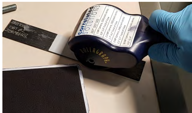
Figura 4.7. Fabricación de patrones de puntos con estampador de rodillo.
