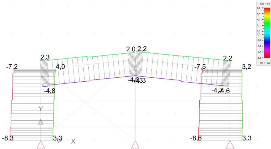
Imatge 43: Diagrama d'esforços axials del pòrtic central.
