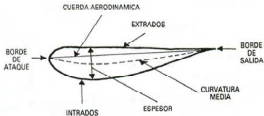
Figura A4. Perfil alar típic d'un aleró de competició com l'EuroFormula Open i la Fórmula 1, entre d'altres.
