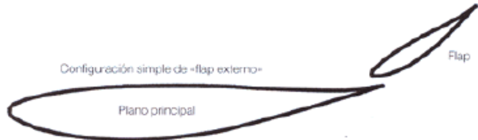
Figura 10. Vista de perfil d'un aleró amb flap.
