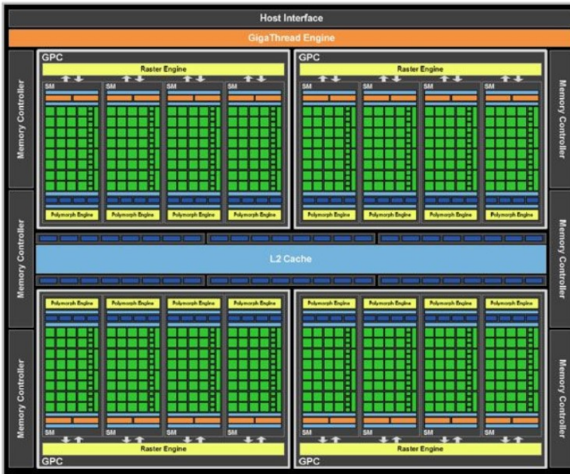
Figura 8. Arquitectura d'una targeta gràfica CUDA
