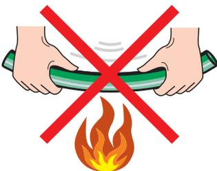
**El cruzamiento de las tuberías se hace con elementos especiales para este fin.**
