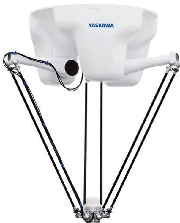
Figura 2. Robot paral·lel tipus delta de Motoman Robotics division, Yaskawa America Inc.
