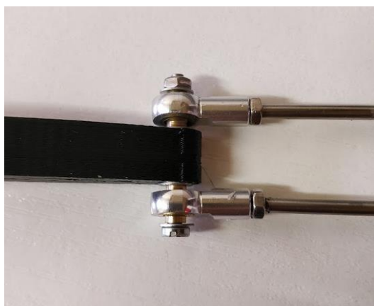
Figura 19. Unió braç superior i inferior
