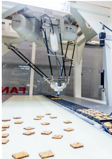
Figura 3. Robot delta utilitzat en el sector de l'alimentació, del fabricant Fanuc
