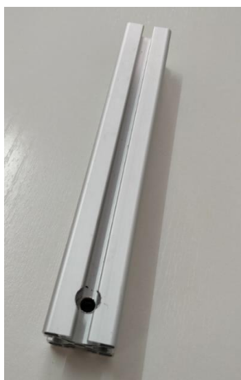
Figura 12. Imatge de les mecanitzacions dels perfils 1 i 3
