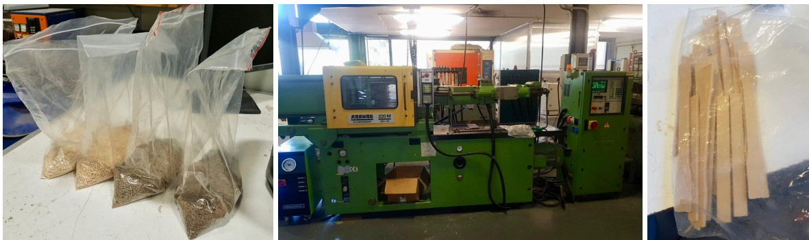
Ilustraciones 19, 20 y 21: composito antes y después del proceso de inyección
