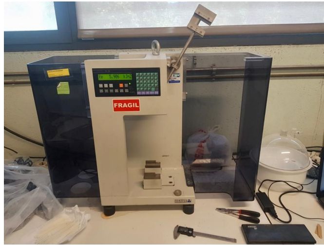
Ilustración 24: péndulo de Charpy
