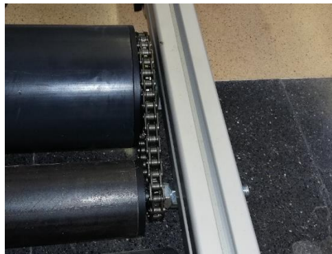
Fig. 17: Transmissió corró d'inèrcia actual
