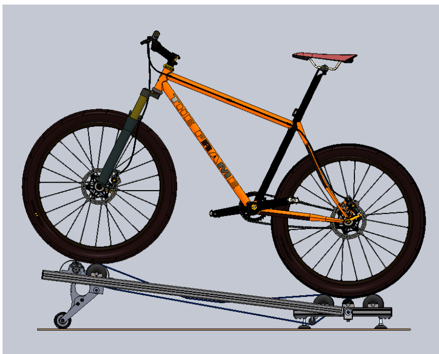
Fig. 5: Banc de corrons proposat en pendent del 15%
