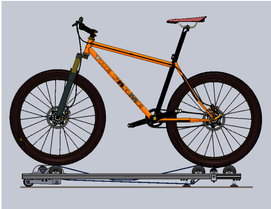
Fig.4: Banc de corrons proposat en estat horitzontal
