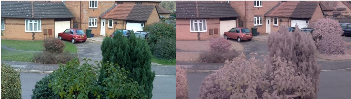
Figura 7. A l'esquerra, fotografia capturada amb una càmera estàndard; a la dreta, fotografia capturada amb una càmera sense filtre IR. Autor: Alex Eames. Extret de Comparison of RasPiCam and Pi NoIR output in daylight . Font: https://raspi.tv/2013/pinoir-whats-it-for-comparison-of-raspicam-and-pi-noir-output-in-daylight
