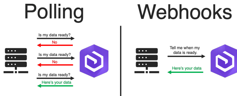
Figura 27. Comparació gràfica entre la tècnica de long polling (a l'esquerra) i la tècnica dels webhooks (a la dreta). Extret de Aprendiendo Arduino . Font: https://www.process.st/wp-content/uploads/2019/10/webhooks-vs-apis.png
