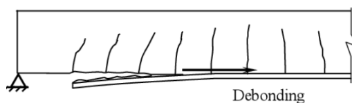
Figura 3 Esquema de l'interfacial debonding
