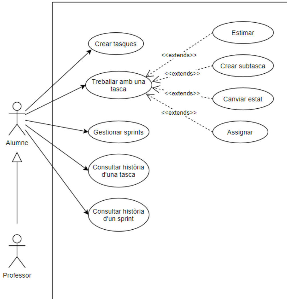
Il·lustració 11 Diagrama de casos d'ús de gestió de backlogs, tasques i sprints
