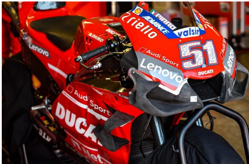
Figura 27 Sistema aerodinàmic davant de la Ducati Desmosedici GP20
