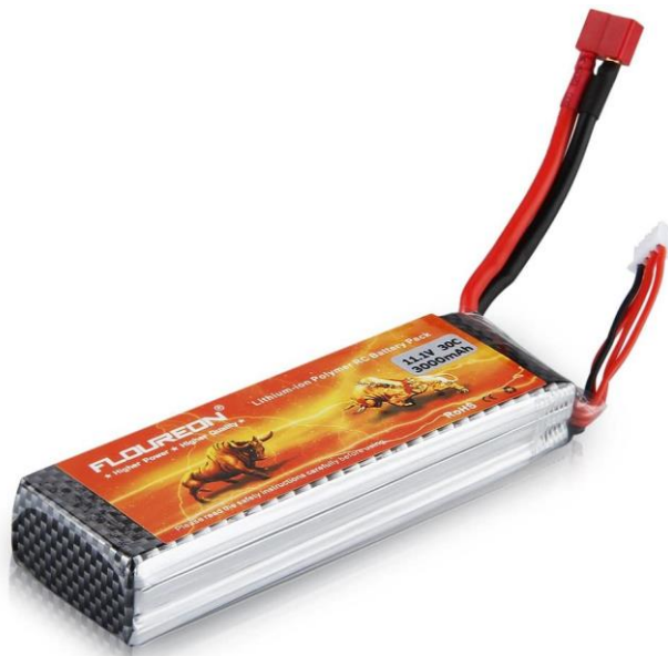
Figura 6. 1. 5: Bateria LiPo de 3S, 3000mAh i 30C.
