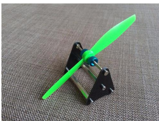
Figura 7. 2. 8: Balancejador d'hèlix amb una hèlix descompensada.
