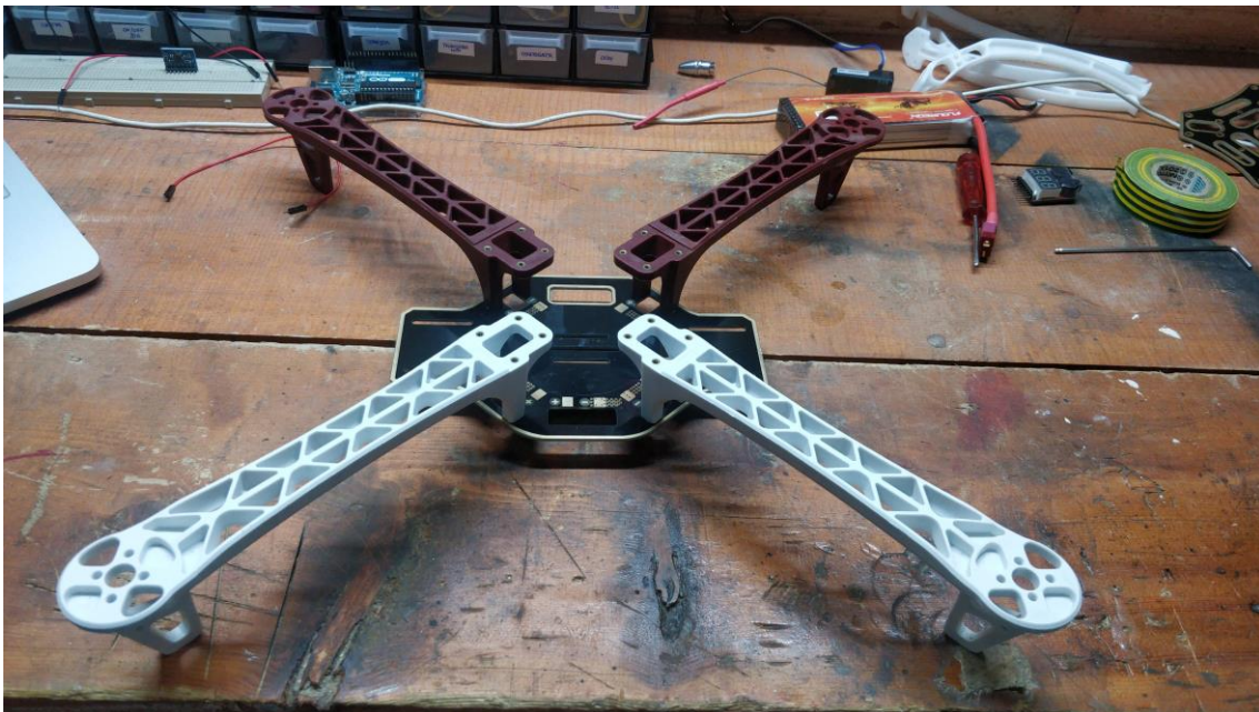
Figura 10. 1. 1: Inici muntatge del frame.
