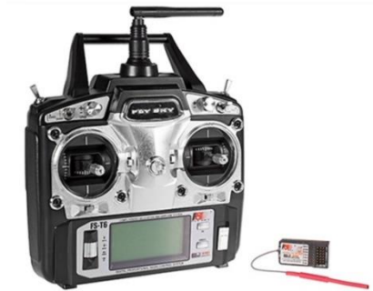
Figura 6. 1. 2: Comandament Flysky FS-T6 amb receptor Flysky FS-R6B de 6 canals.
