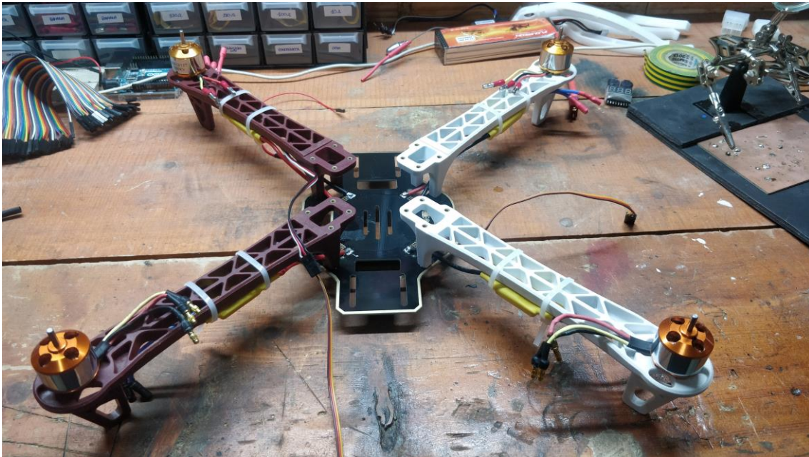
Figura 10. 1. 2: Connexions dels ESC a la placa de distribució de potència i motors muntats.
