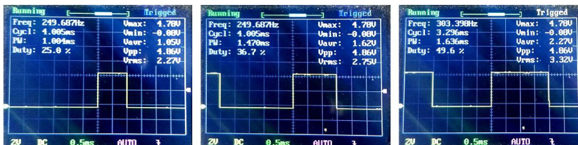
Figura 8. 3. 2: Senyals PWM llegides amb l'oscil·loscopi.
