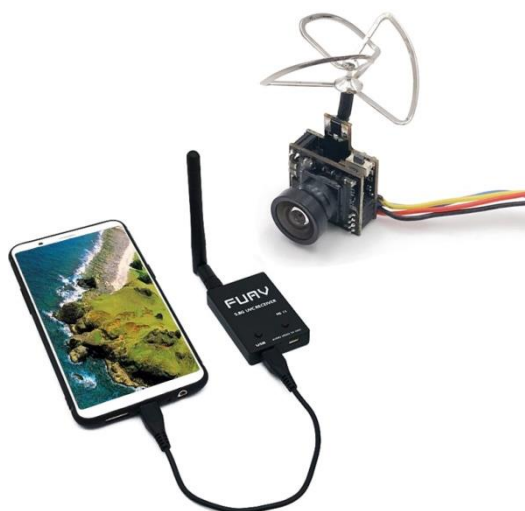
Figura 12. 1: Càmera FPV amb receptor que ens permet visualitzar la imatge al mòbil.
