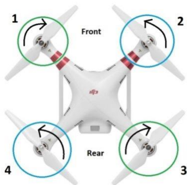
Figura 4. 3. 1: Estructura i funcionament de les hèlixs d'un quadcopter
