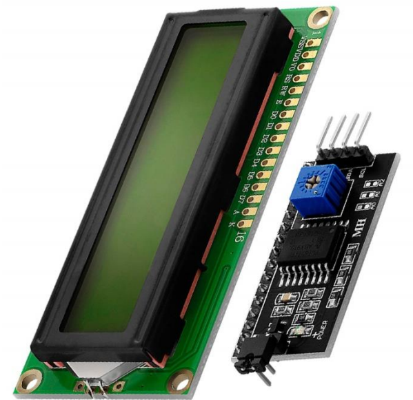
Figura 6. 2. 4: LCD 16x2 i adaptador I 2 C.
