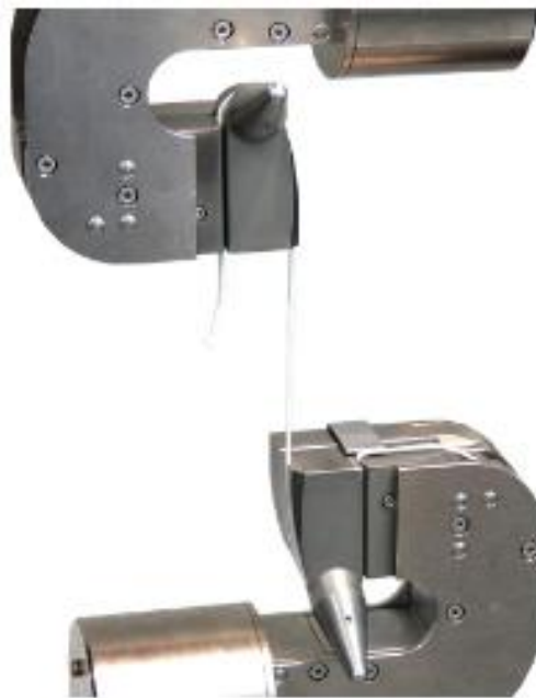
Figura C10: Pincas amb el sistema de corba de reducció de força amb una zona corba de 180°.
