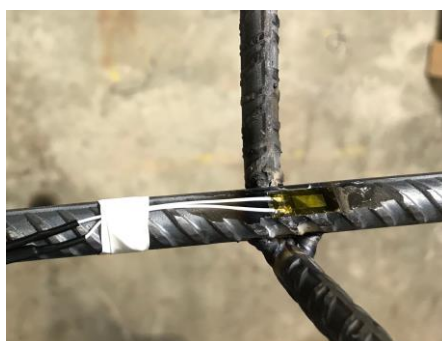
Figura 31: Col·locació de galgues extensomètriques en l'armadura
