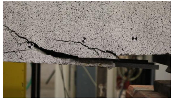
Figura 18: Mode de ruptura de S7 per falla de adherència
