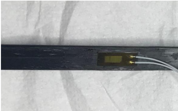
Figura 34: Col·locació de la galga a la barra de FRP.
