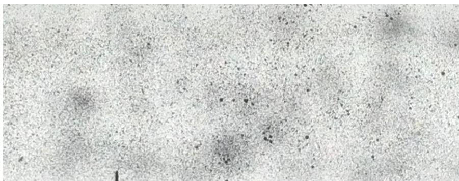
Figura 36: Superfície preparada del espècimen.
