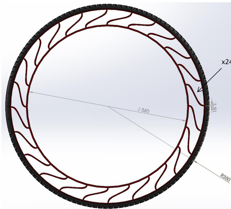
Figura 8 : Dimensions principals del disseny final
