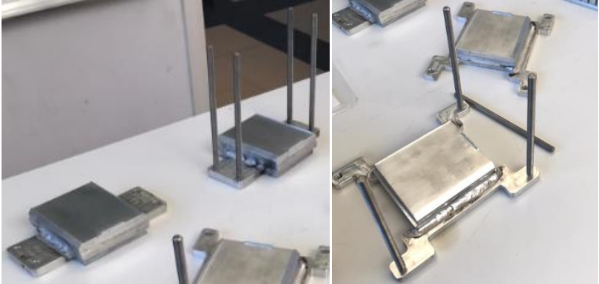
Figura 28. Brides del termoelèctric.
