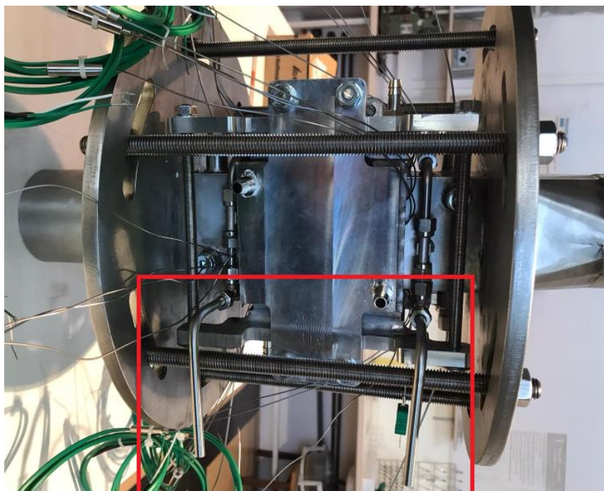
Figura 35. Detall dels tubs units al circuit de pressió per facilitar l'obtenció de dades.
