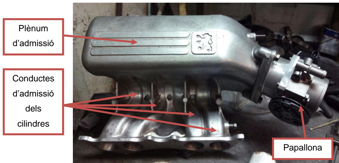
Figura 83: Colector d'admissió de Peugeot 106 Rallie i papallona
