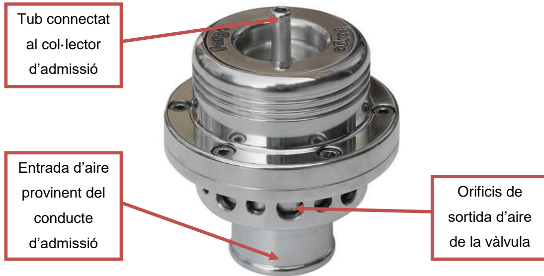
Figura 90: Vàlvula de descàrrega (forgemotorsport. 2020)
