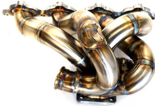
Figura 32: Col·lectors d'escapament de competició per Mitsubishi EVO VI (Sheeprace. 2020)
