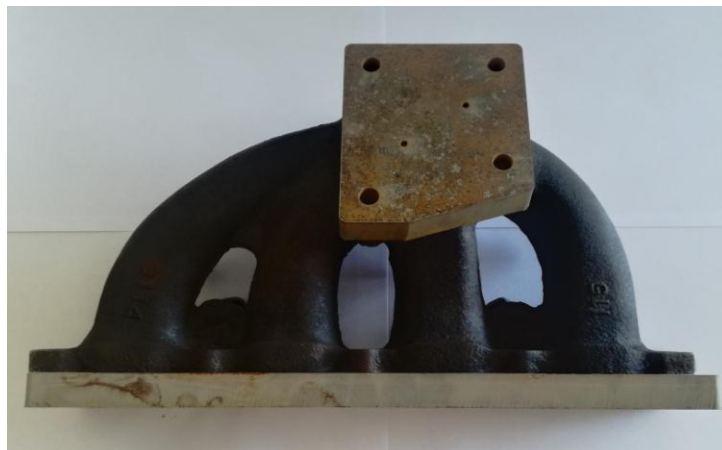
Figura 72: Plaques de l'estructura guia col·locades en els col·lectors de sèrie
