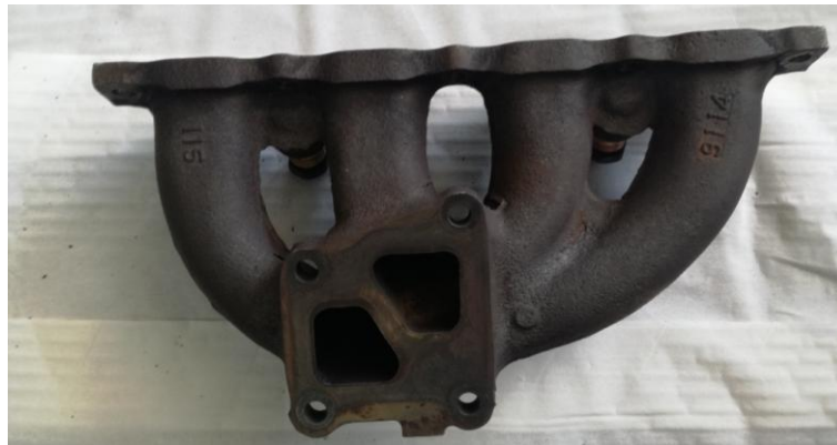
Figura 14: Col·lectors d'escapament del motor a estudiar
