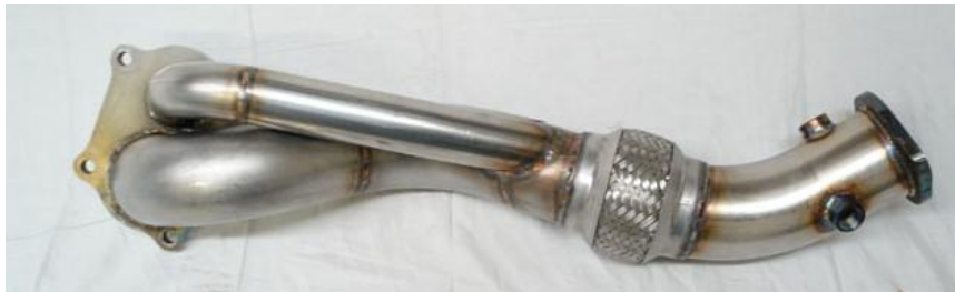
Figura 33: Downpipe de competició per Mitsubishi EVO VI (J-Spec Performance. 2020)
