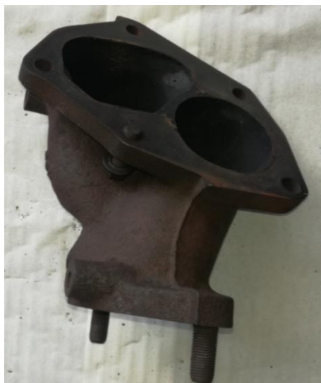
Figura 24: Downpipe del motor a estudiar
