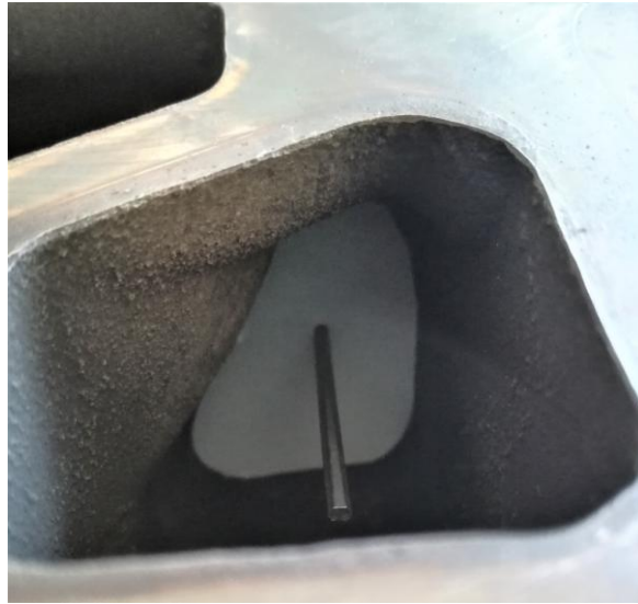
Figura 19: Calca dins un conducte del col·lector d'escapament
