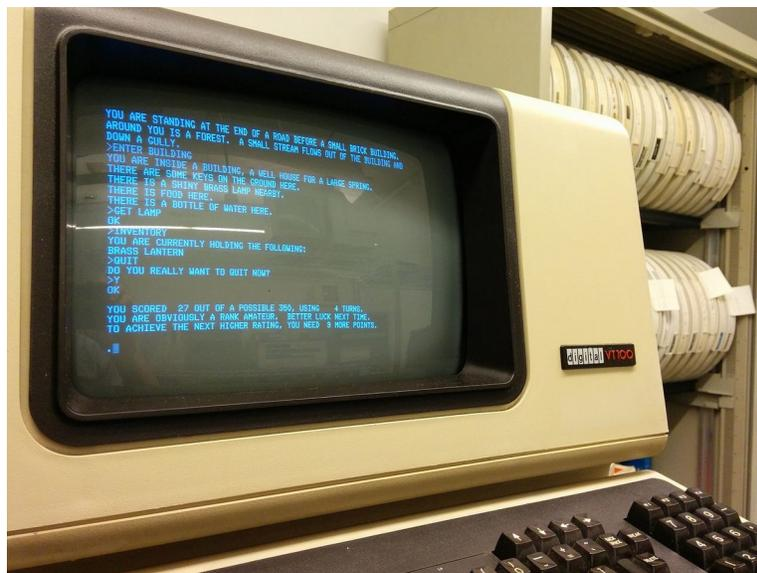
Figura 2.1 - Adventure ejecutándose en un PDP-11/34 mediante una consola VT100
