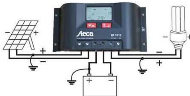
Figura 13: Esquema regulador de carga
