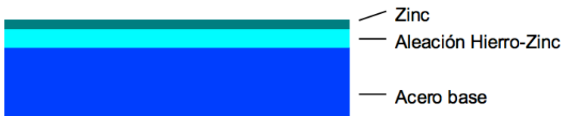
Figura 30: Capes aplicables al galvanitzat
