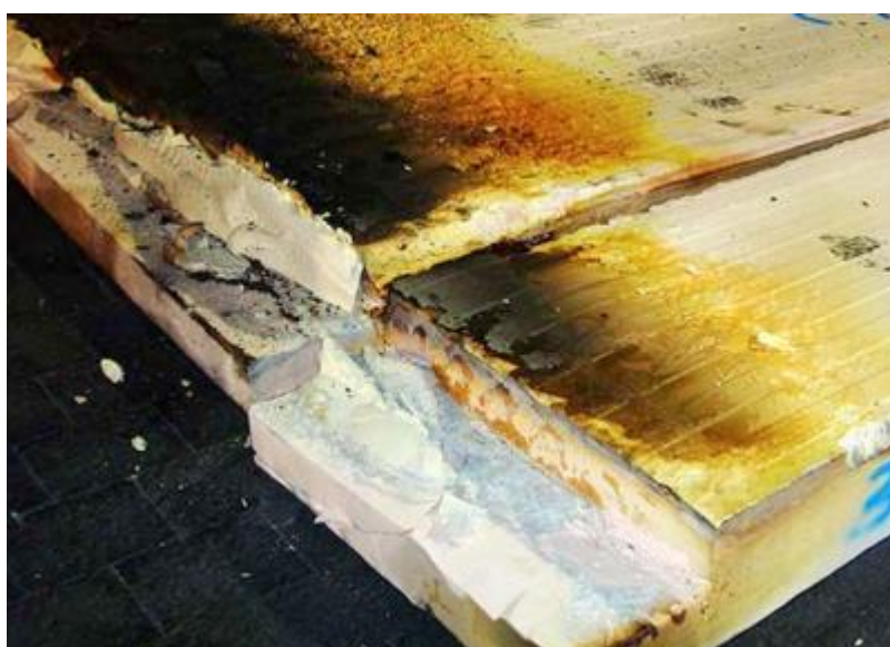
Figura 28: Panell Sandwich amb protecció BS1D0
