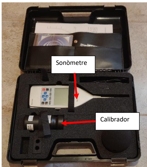
Figura 16: Sonòmetre CESVA SC420 (esquerra)
