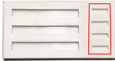
Figura 8 : En el rectangle, motlles on s'han produït els compòsits.
