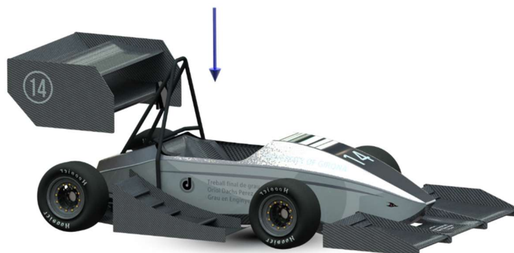
Il·lustració 3 Vehicle sotmès a heave o enfosament
