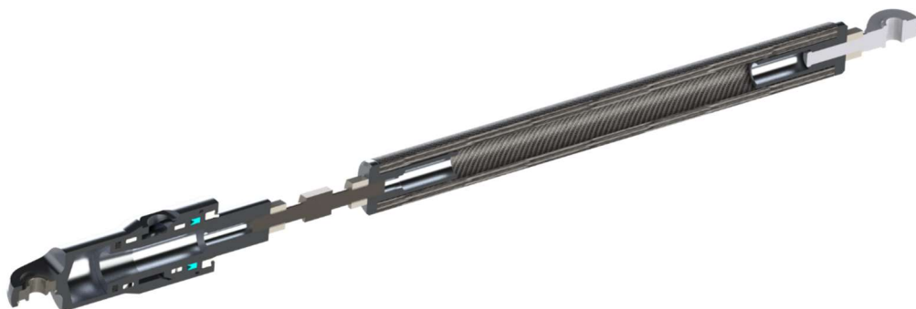
Il·lustració 20 Barra biarticulada de suspensió seccionada
