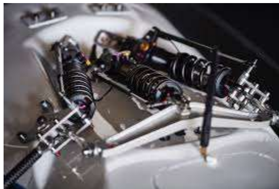
Il·lustració 9 Sistema tercer esmorteïdor/molla
