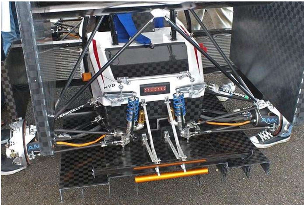
Il·lustració 7 Suspensió amb barra antibalanceig
