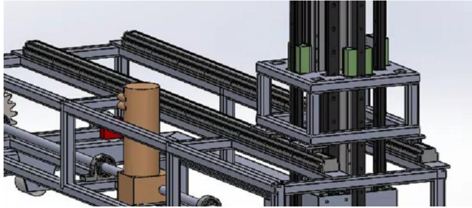
Figura 15: detall d'actuadors lineals del carro gran. Font: elaboració pròpia.
