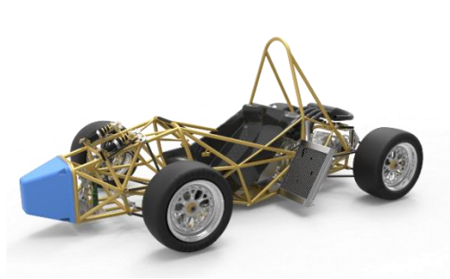
Imatge 2 - Exemple de xassís tubular.
