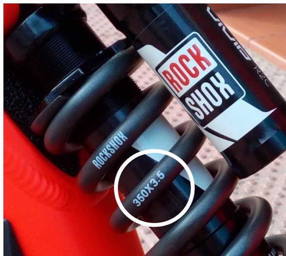
Figura C.2. Rigidesa de la molla de l'amortidor indicada a la pròpia bicicleta
