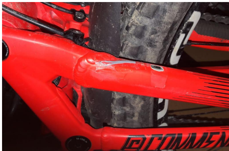
Figura D.4. Galga al basculant per veure possibles relacions
