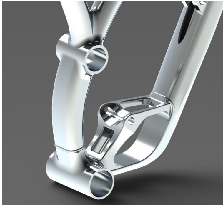
Figura 4.3. Detall de la geometria final del quadre
