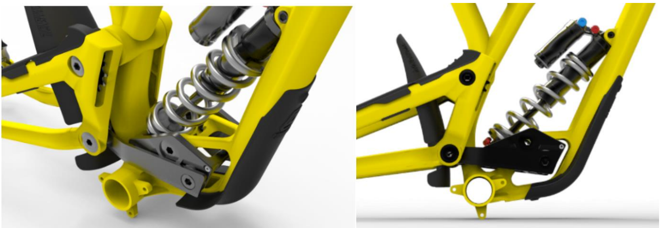
Figura 1.5. Detall de les bieletes del conjunt (Font: commencal-store.es )
